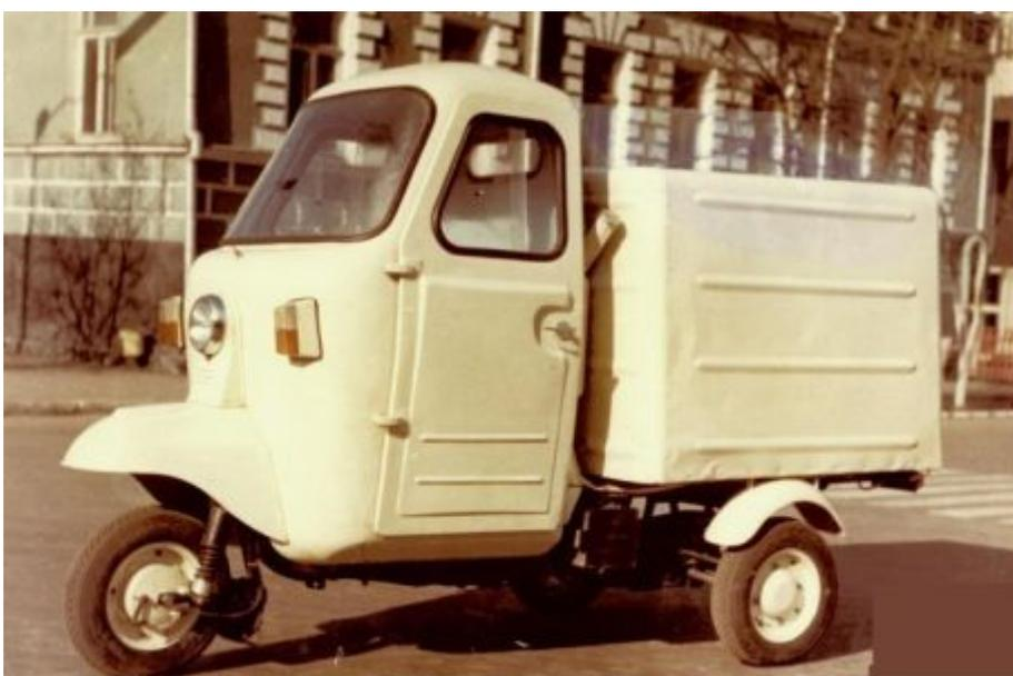
Рис 15. Грузовой вариант мотороллера «Пула»
