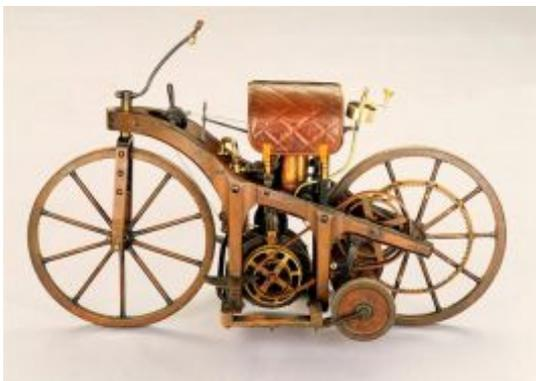
Рис. 1. Первый бензомоторный двухколесный экипаж Даймлера — Бенца с мотором 1 л. с.
